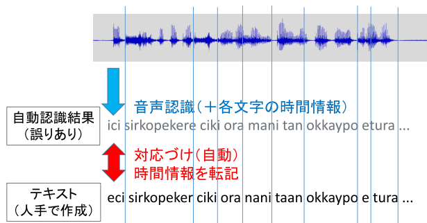
図-3 音声とテキストのアライメント処理
